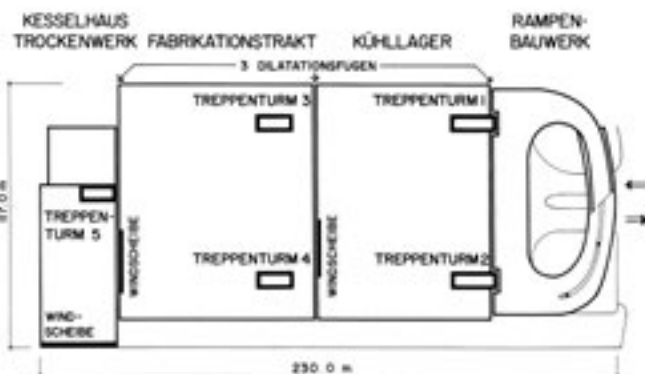
Alter Grundriss: Drei quer verlaufende Dilatationsfugen gliedern das Bauwerk in vier Teile. Jeweils zwei Treppenkerne und eine Windscheibe stabilisieren Fabrikationstrakt und Kühlager – damals wie auch heute (vgl. Grundriss rechts).
